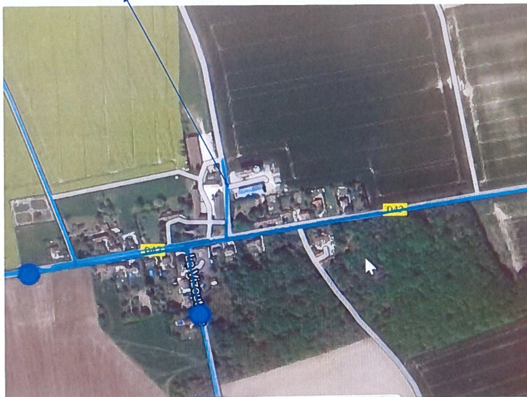
Canalisation PVC DN50 de 120 ml qui sera remplacée.
